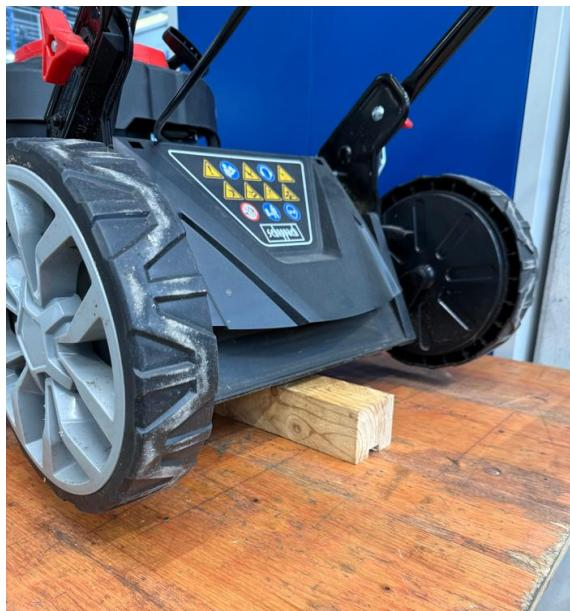
Unterbauen Sie den Rasenmäher hinten so, dass er stabil steht und die Hinterräder vom Boden abgehoben sind.
