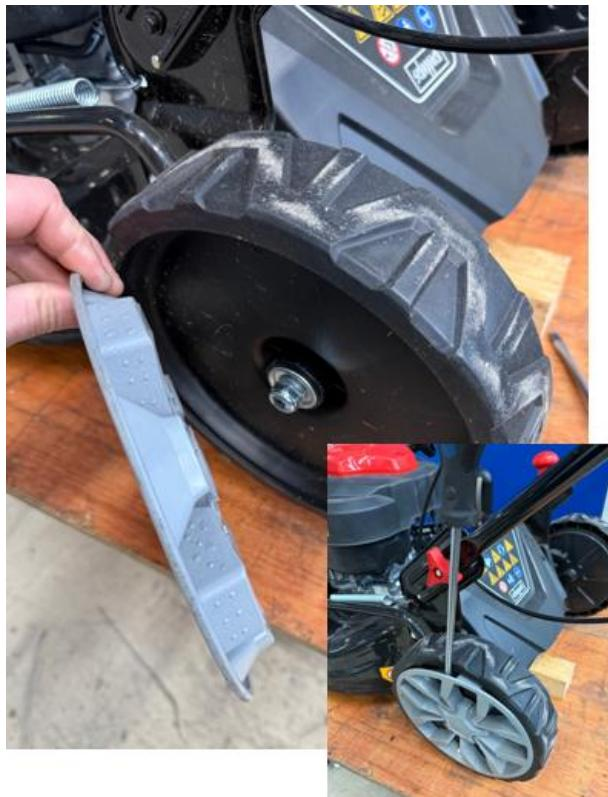
Nehmen Sie die Radkappe vom hinteren Rad ab. Diese ist nur gesteckt und kann mit Hilfe eines Schraubendrehers heruntergedrückt werden.
