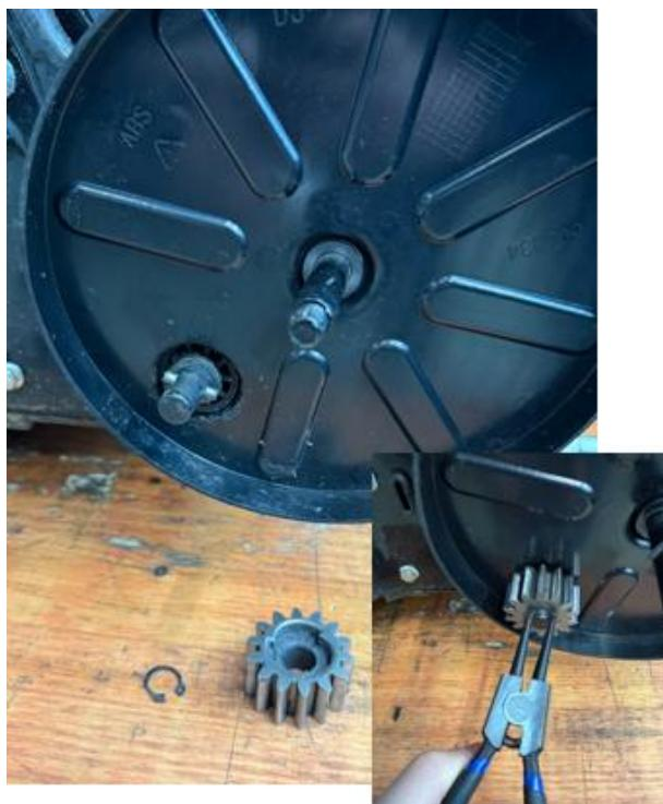
Entfernen Sie den Seegering mit einer geeigneten Seegering-Zange und nehmen Sie das Zahnrad ab.
