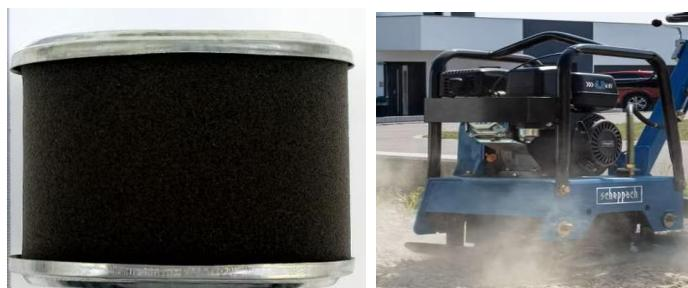
Daher empfehlen wir den Luftfiltereinsatz in regelmäßigen Abständen zu kontrollieren und bei Bedarf entsprechend zu reinigen.
