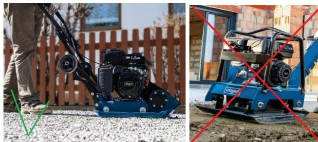
Hintergrund ist hier, dass bei einem Schiefstand der verbaute Ölwanter nicht mit genügend Öl in Berührung kommt. Was wiederum dazu führt, das der Zündfunke durch den verbauten Ölwanter nicht freigegeben wird.
