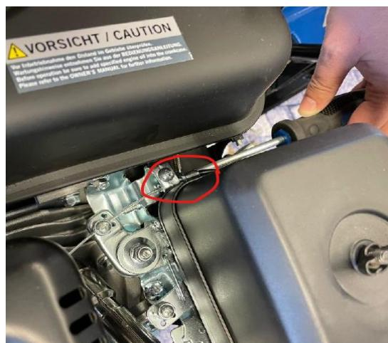
In diesem Fall genügt es, wenn die [Anschlagsschraube](#) um ein bis zwei Umdrehungen zurückgedreht wird.
