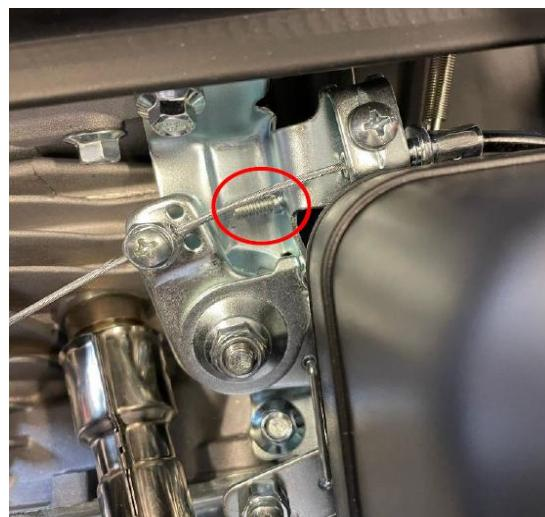
Diese [Anschlagsschraube](#) ist zu weit eingedreht und dadurch kommt die Rüttelplatte nicht auf die richtige Drehzahl.
