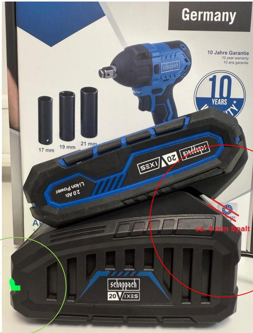
Wenn der Akku korrekt ins Ladegerät eingesetzt ist, bleibt ein Spalt von etwa 4 mm (im Bild **rot** gekennzeichnet). Nach wenigen Sekunden leuchtet oder blinkt die **grüne LED** auf dem Ladegerät, abhängig vom Ladezustand. Der Akku ist somit vollständig eingesteckt und wird geladen.
